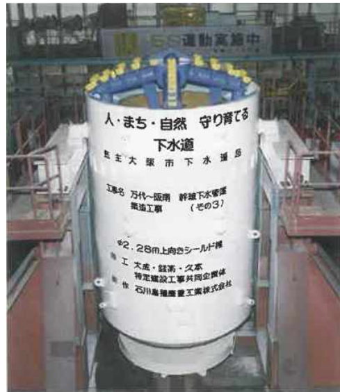
사진-8 상향실드 9) (오사카시 하수도국 반다이~사카미나미 간선)
