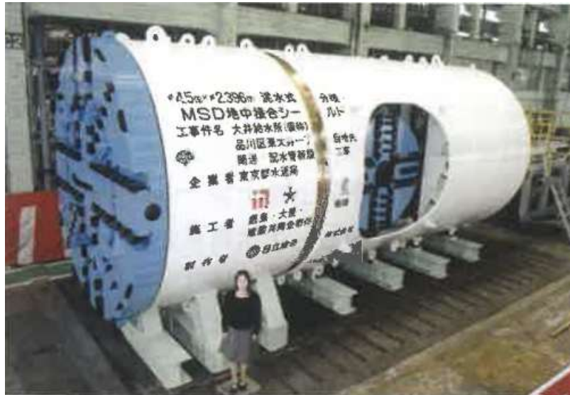
사진-6 직각분기실드 6) (도쿄도 수도국 오오이 급수처배수관)
