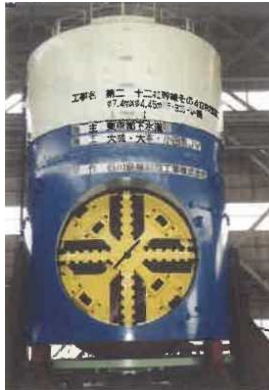
사진-4 구체실드(타테요코방식) 4) (도쿄 하수도 제2주니소 간선)
