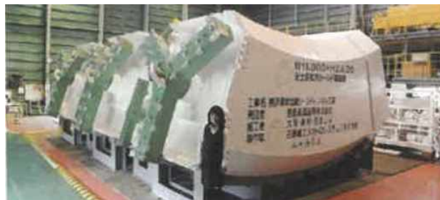
사진-11 확대원주실드 13) (슈토고속도로 요코하마 칸쥬키타선 실드)
