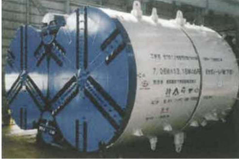
사진-1 H&V 실드 2) (지하철 12호선 롯본기역 공구)
