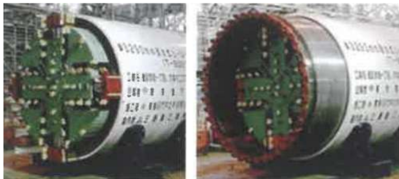
사진-9 T-BOSS공법 실드 10) (도쿄도 하수도 미나토구 아카사카롯본기 재구축)
